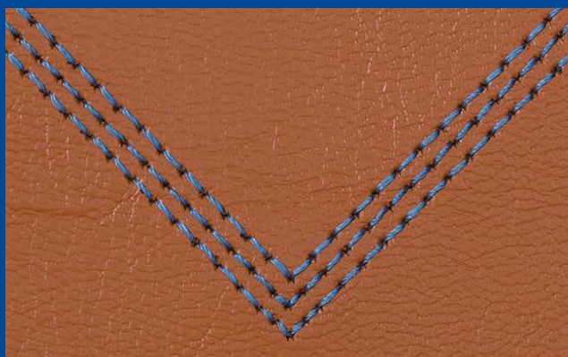
Velocidad de costura: 2.800 pun/in, longitud de puntada: 4mm
